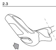
Poussez le grips et le prolongateur sur le guidon jusqu'à la marque à 140 mm.
