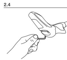
Serrez le collier de serrage pour que le grip et le prolongateur puissent encore être ôtés.
