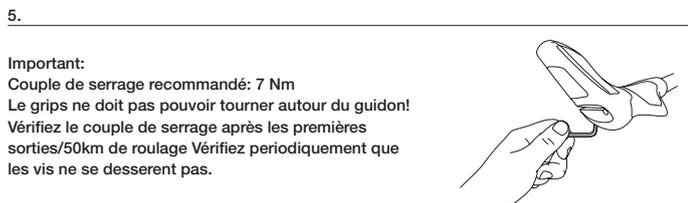
Serrez les vis à 7 Nm en utilisant une clé dynamométrique et un embout allen de 5 mm. Vérifiez le couple de serrage après les premières sorties/50km de roulage Vérifiez périodiquement que les vis ne se desserrent pas.
