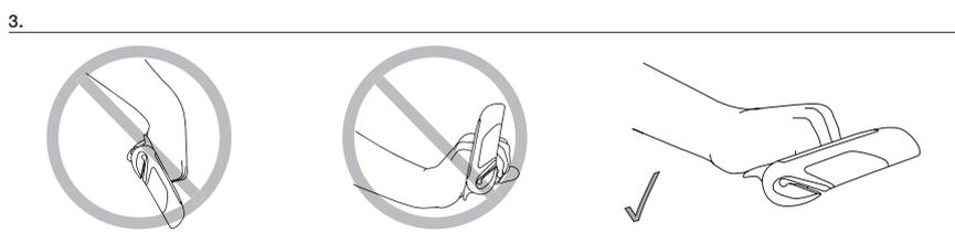
Tournez le grip pour que la plate forme supporte complètement la paume de votre main. Le poignet doit être dans une position neutre sans pliure exagérée. Après une courte période d'essai une position doit être trouvée. Assurez-vous de serrer le collier à 7 Nm avant de rouler.
