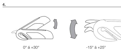
La position par défaut de la plate forme de support est horizontale. Pour un ajustement fin au pilote et au style de pilotage, référez-vous à l'étape 3 et aux conseils donnés en dessous.
