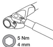
Ziehen Sie die Klemmschrauben der Griffe mit einem 4 mm Drehmomentschlüssel mit 5 Nm an. Ziehen Sie in jedem Fall die Klemmschrauben der Barends nach 50 km bzw. der ersten Fahrt nach.
