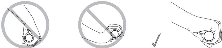
Drehen Sie die Auflagefläche der Griffe so, dass Ihre Handballen vollflächig aufliegen. Eine übermäßig abgewinkelte Position des Handgelenks sollte hierbei vermieden werden. Durch Ausprobieren können Sie die für Sie komfortabelste Stellung der Ergon Handgriffe herausfinden. Ziehen Sie die Klemmschrauben der Klemmen in jedem Fall vor der ersten Fahrt mit 5 Nm fest.
