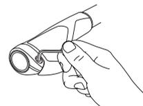
Serrez le collier de serrage pour que le grip et le prolongateur puissent encore être ôtés.
