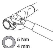
Serrez les vis à 5 Nm en utilisant une clé dynamométrique et un embout allen de 4 mm. Vérifiez le couple de serrage après les premières sorties/50 km de roulage Vérifiez périodiquement que les vis ne se desserrent pas.
