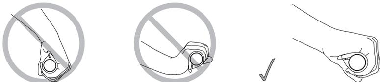
Tournez le grip pour que la plate forme supporte complètement la paume de votre main. Le poignet doit être dans une position neutre sans pliure exagérée. Après une courte période d'essai une position doit être trouvée. Assurez-vous de serrer le collier à 5 Nm avant de rouler.
